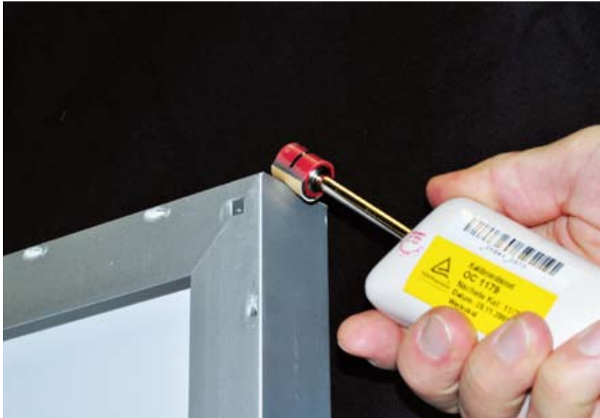
Rund 25 Messwerte nehmen die Experten an einem Modultyp auf. Mit dieser Fingeratruppe testen sie, wie hoch das Risiko ist, dass sich Installateure an scharfen Kanten verletzen.
