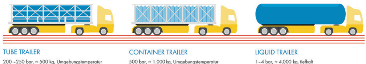
Bild 20. Straßentransport von Wasserstoff (Quelle: Shell)
